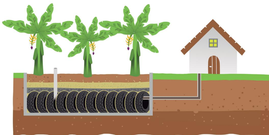
A fossa de bananeiras, ou tanque de evapotranspiração, é um método barato e eficaz, pois trata as águas negras (do vaso sanitário) e não tem efluente, ou seja, não sai água dela. As bananeiras plantadas em cima da fossa fazem o trabalho final de filtrar essa água com as suas raízes e a devolvem para a atmosfera através da respiração da folha em forma de vapor.
